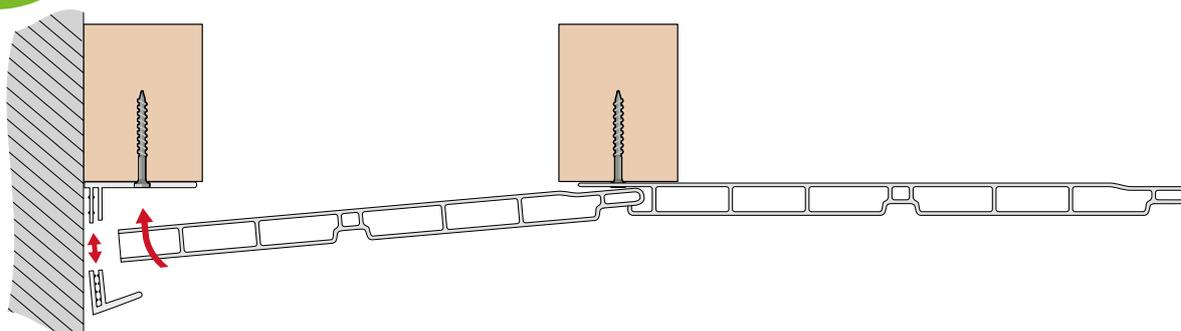
Ajustez et découpez dans sa longueur **la dernière lame** pour l'adapter à la distance (moins 1 cm) entre votre fond de profilé de maintien (**U clipsable UCLIP** par exemple) et l'avant-dernière lame, emboîtez-la, puis refermez le **UCLIP**.
