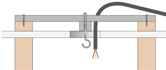
Pour un **éclairage suspendu lourd** (type **lustre**), il est préconisé de fixer cet élément lourd à la structure porteuse du faux-plafond avec une traverse adaptée, voire à la charpente de la toiture au dessus.
