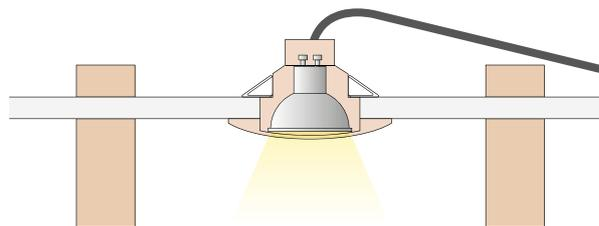
Pour un **éclairage encastré** (type **spot**), son poids ne devra pas dépasser 2 Kg. La puissance électrique maximale est de 20 W maximum.
