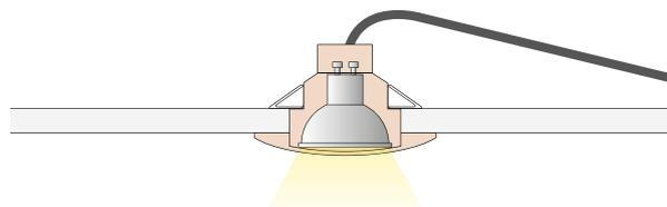
Pour un **éclairage encastré** (type **spot**), son poids ne devra pas dépasser 2 Kg. La puissance électrique maximale est de 20 W maximum.
