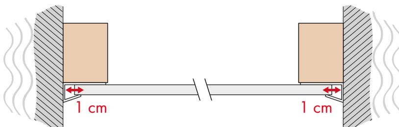
**Attention**, la longueur des lames doit rester **inférieure** à la dimension mesurée entre murs (entre 2 et 3 cm de moins) pour faciliter la pose et prévenir contre toute casse et chute de ces dernières lors d'un **évènement sismique**.
