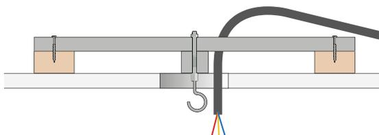
Pour un **éclairage suspendu lourd** (type **lustre**), il est préconisé de fixer cet élément lourd à la structure porteuse du faux-plafond avec une traverse adaptée, voire à la charpente de la toiture au dessus.
