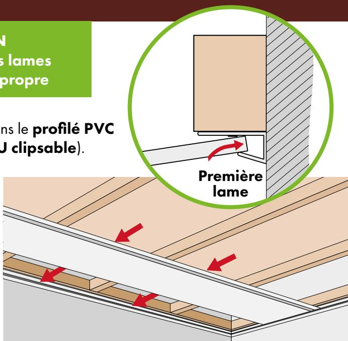
Fixez la lame avec des **vis Ø 3,5 mm x 25 mm** dans sa large languette au **croisement** de chaque liteau de bois (ou rail métallique). Les vis sont cachées par le recouvrement de la lame suivante.
